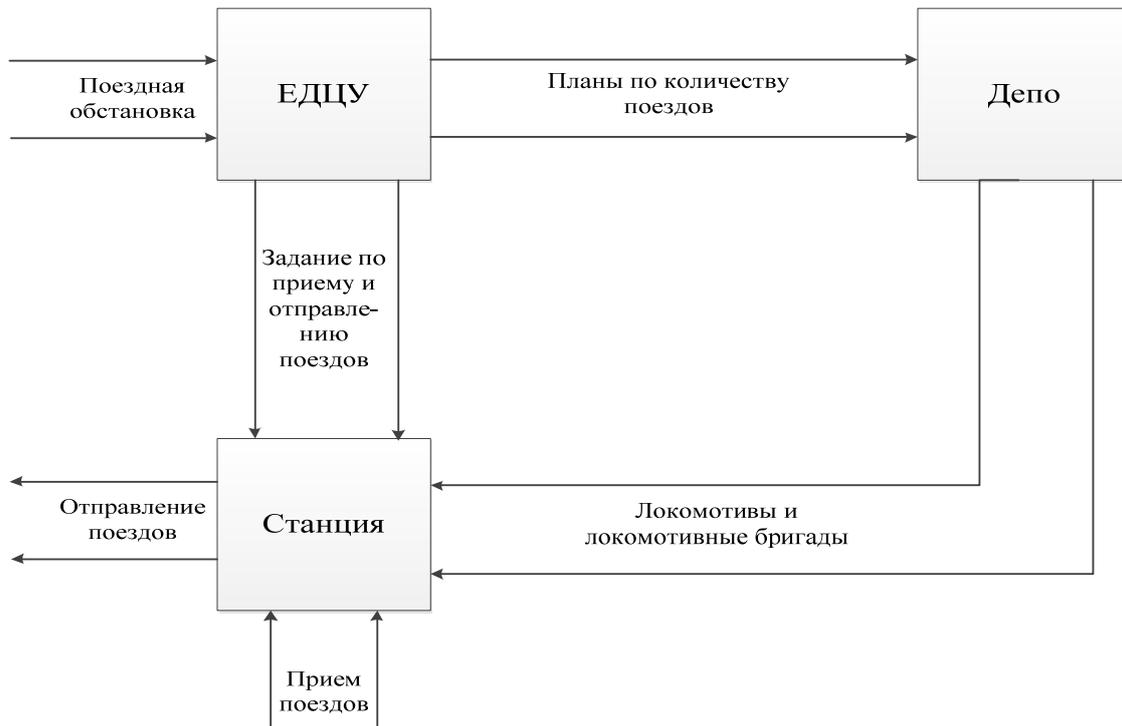
Рис. 1. Схема взаимодействия ЕДЦУ, депо и станции
