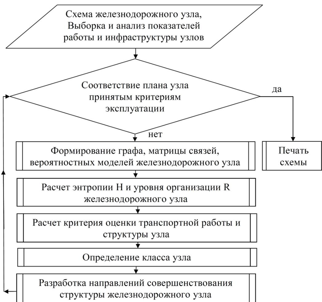
Рис. 7. Последовательность оценки структуры железнодорожного узла
