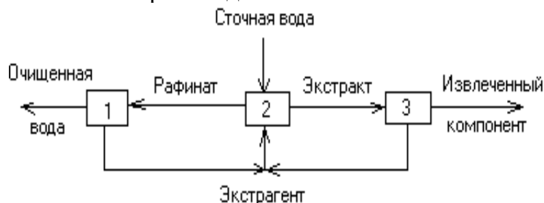
Рис. 17 Схема непрерывной противоточной экстракции: 1 – система для удаления экстрагента из рафината; 2 – экстракционная колонна; 3 – система для удаления экстрагента из экстракта
