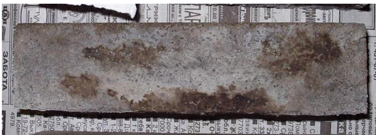
Рисунок 33. Поверхность бетона со шпалами после тепловлажностной обработки
