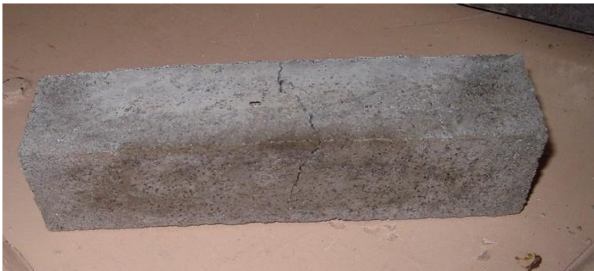
Рисунок 32. Образец шпалобетона после испытания на изгиб
