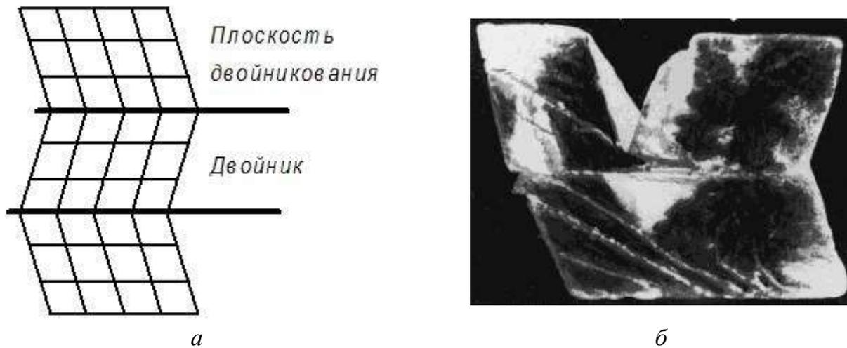
Рис. 1.9. Схема двойникования (а) и двойникование в реальном кристалле (б)
