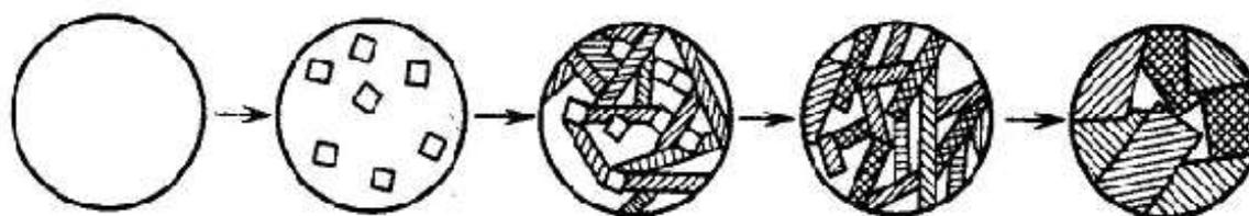
Рис. 9.4. Схема кристаллизации стекла при образовании ситаллов
