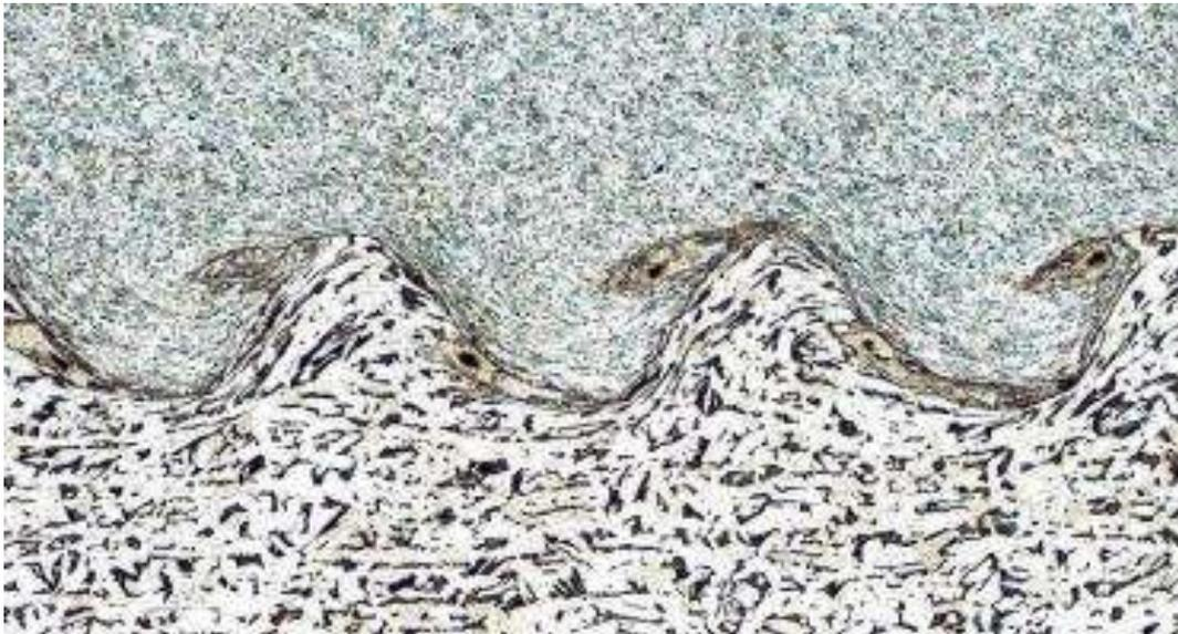
*Рис. 16.41.* Типичная граница раздела деталей, свариваемых сваркой взрывом
