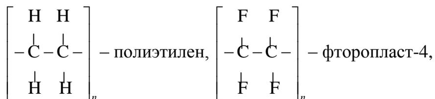
являются высококачественными диэлектриками, обладают хорошей морозостойкостью, но имеют небольшую прочность ( $\sigma_B = 20\text{--}45$  МПа).
