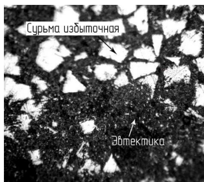
Рис. 4.5. Сплав Pb-Sb с ликвацией по удельной массе
