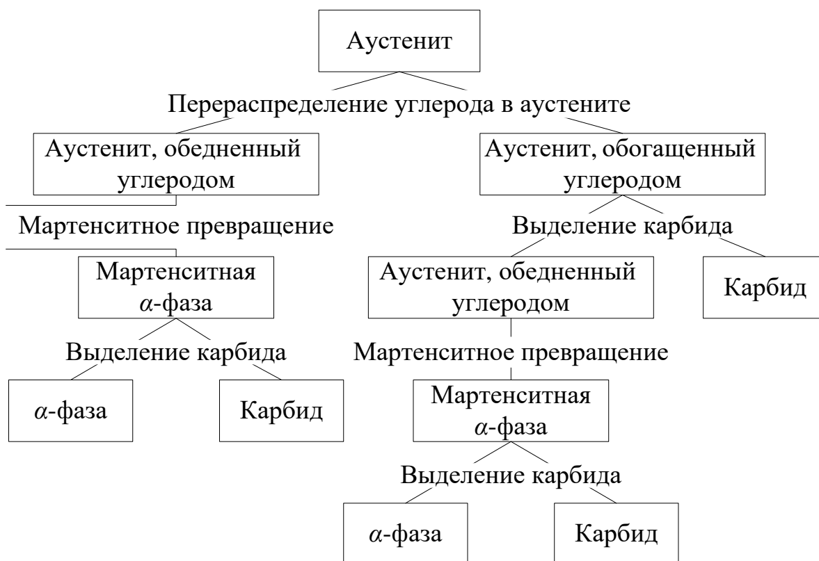
Рис. 7.15. Схема бейнитного превращения
