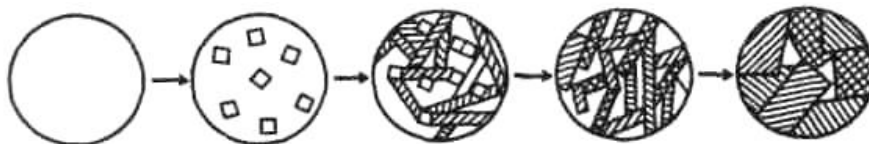
Рис. 11.13. Схема кристаллизации стекла при образовании ситаллов с помощью нуклеаторов
