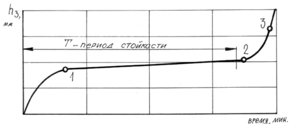
Рис. 23.7 Кривая износа по задней поверхности
