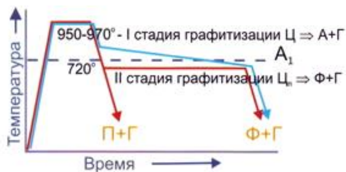
Рис. 6.7. Схема отжига белого чугуна на ковкий чугун
