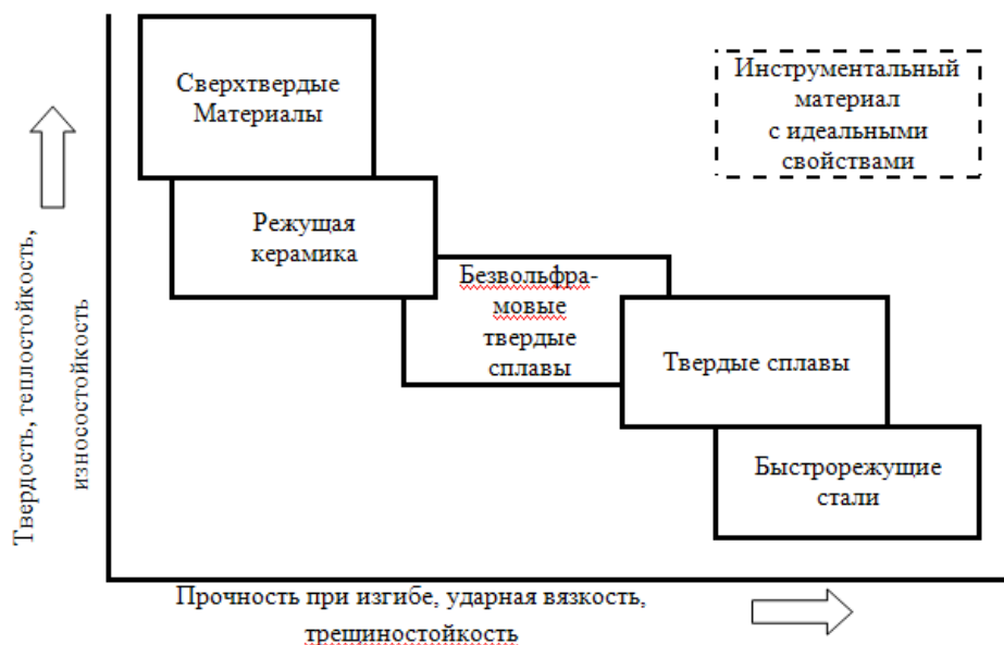
Рис. 22.6. Сравнительные свойства инструментальных материалов
