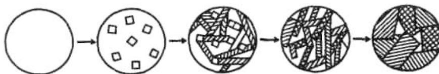
Рис. 7.13. Схема кристаллизации стекла при образовании ситаллов с помощью нуклеаторов
