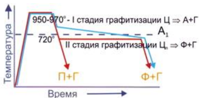
Рис. 4.7. Схема отжига белого чугуна на ковкий чугун
