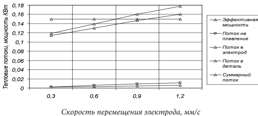
Рис. 18. Баланс тепловых потоков при плазменной сварке стальной заготовки при токе I = 10 А, U = 20 В, ширина фаски сварного шва f = 1 мм
